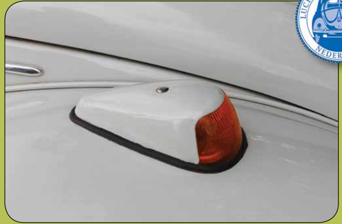
Het knipperlichthuisje is in de kleur van de Kever i.p.v. chroom
