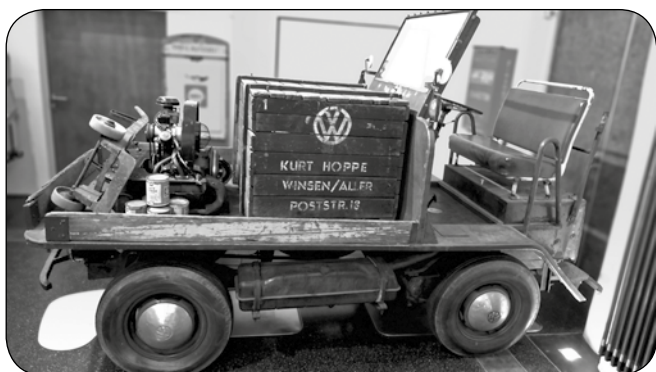
De 'Plattenwagen', een verbouwde Kever voor intern transport in de Volkswagenfabriek, leverde de inspiratie op voor het ontwerp van de Volkswagenbus
