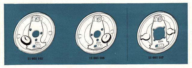
Damit Ihnen das Erkennen leichter fällt, sind die Bremsträger in der Lage dargestellt, daß die Lagerböcke jeweils oben zu liegen kommen. Bei den hinteren Bremsträgern entspricht diese Anordnung der Lage im eingebauten Zustand am Fahrzeug. Mechanische Bremse — Personenwagen (Typ 1):
