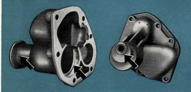
305 205 Schaltgehäuse zum nachträglichen Einbau von Synchrongetriebe in Wagen Typ 1 bis Fahrgestell-Nr.: 1—397 022 Für Typ 2 ab Fahrgestell-Nr.: 20—041 712
